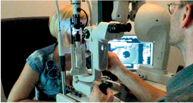
Bild 2: Infrarot-Pupilloskopie mit dem BG-5-Meibographiesystem
